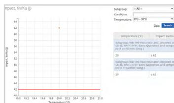
只需点击材料对应的矩形,即可看到该材料的详细性能数据以及对应的条件。本例中可以看到所有条件下的冲击功数据点,根据下限红线可以看出并非所有条件下的数值都满足要求。
