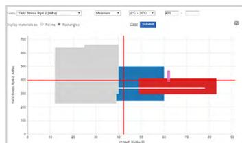
此时还可以根据需要添加数值上下限范围。例如确定需要的最小冲击功为 42 Kv/Ku (J), 最小屈服强度为 400 MPa。如果材料的任一性能的数据完全落在设定的上下限之外,则会显示为灰色,本阶段就可以放弃考虑。
